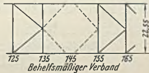
Abb. 9. Flachverband im Untergurt am Bogenschluß.
