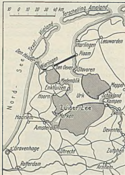
Abb. 1. Plan des Abschlusses und der teilweisen Trockenlegung der Zuidersee nach dem Gesetzentwurf vom Sept. 1916.
