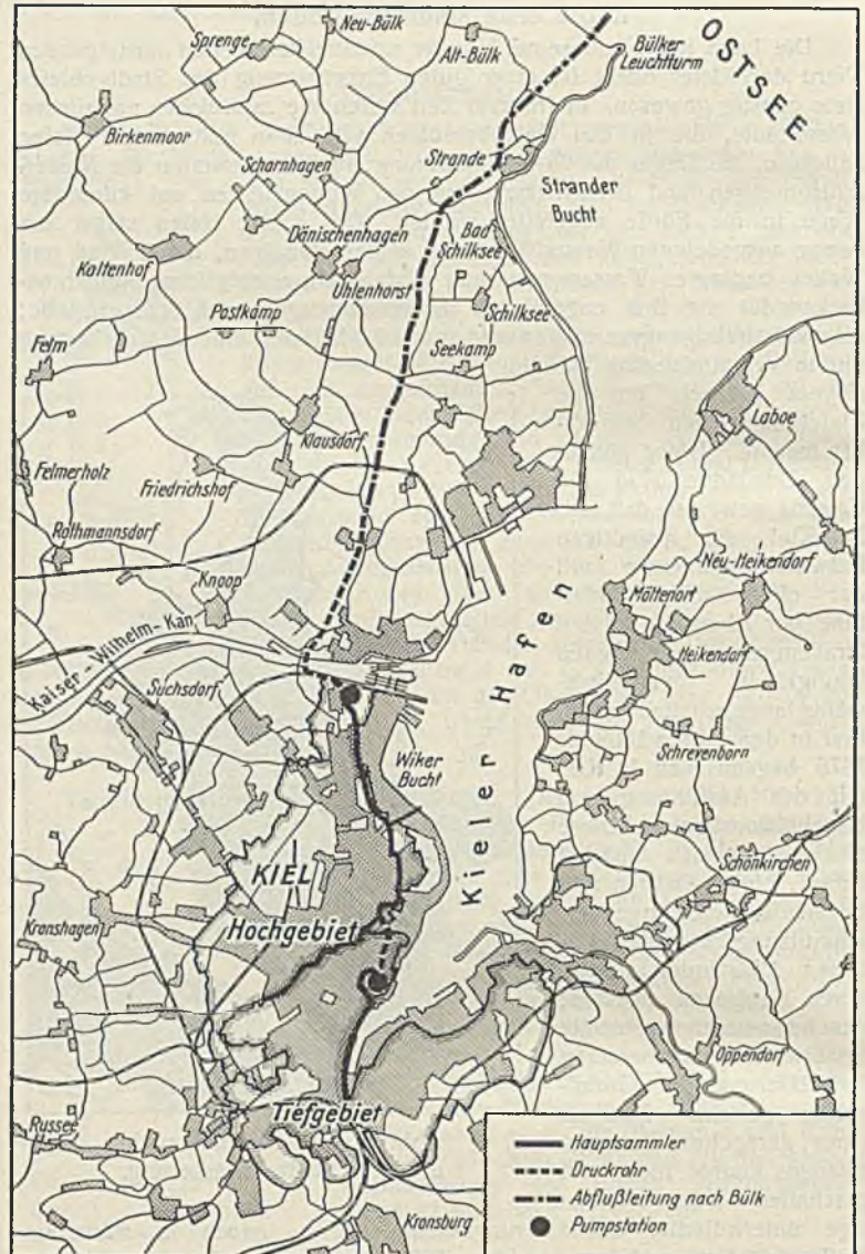
Abb. 2. Übersichtsplan der Vollkanalisation.
