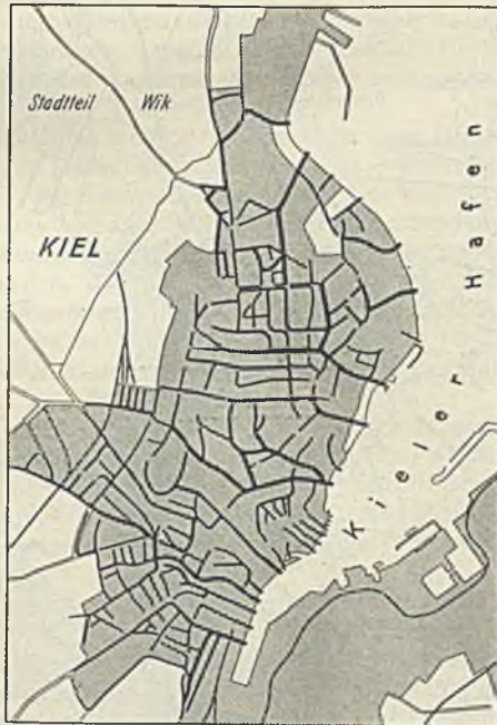
Abb. 1. Die Sammelkanäle der alten Stadtentwässerung.
