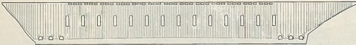
Abb. 5. Ansicht der Sperrmauer mit luftseitigen Mauerdränagen.
