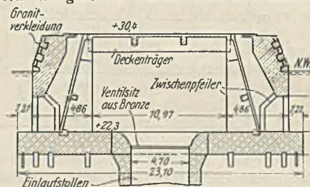
Abb. 3. Querschnitt durch den Einlauf.
