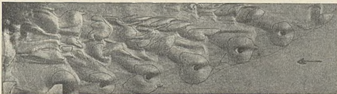
Abb. 11. Modellversuch über die Kolkwirkung an der Brücke.
