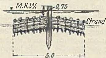
Abb. 7. Durchlässige Pfahlbuhne an der belgischen Küste. etwa 1:225.
