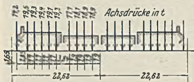
Abb. 4. Übersicht über die senkrechten und waagerechten Verschiebungen des Stahlüberbaues bei der Belastungsprobe und Lastenschema (Achsabstände und Achsdrücke) der Güterzuglokomotive G 56.20 der Bauartreihe 43.
