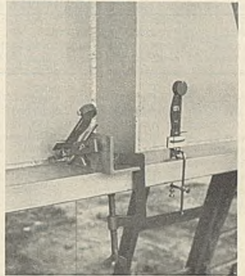
Abb. 10. Tensometer am Untergurt des Hauptträgers 4—5.
