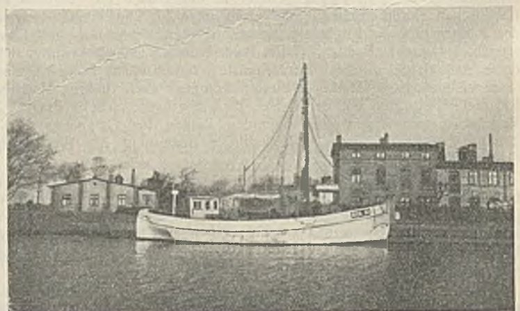
Abb. 2. Hochseekutter „Columbia“ (Rüg Nr. 38), 15,30 m lang, 5,30 m breit, 2,10 m Tiefgang, 68-PS-Benz-Diesel-Motor. Gebaut 1931 in Rügenwalde.
