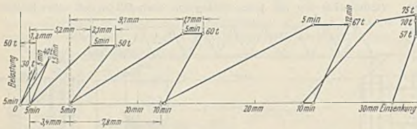
Abb. 3. Ergebnis der Probelastung von Pfahl Nr. 34 am 10. April 1930.
