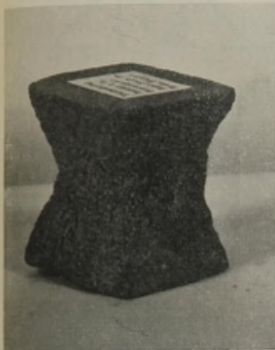
Abb. 15. Betonwürfel nach der Druckprobe.
