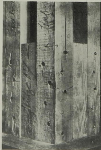
Abb. 45. Stütze 17, Bauart nach Abb. 1 bis 3, nach dem Druckversuch. Zerstörung bei Stab 2 unten.
