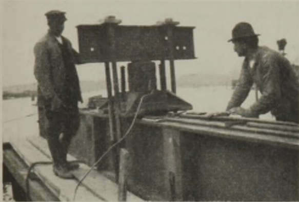
Abb. 20. Einrichtung für die Zugversuche.
