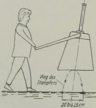
Abb. 1. Skizze des 500-kg- Explosionsstampfers für lose geschütteten Boden.
