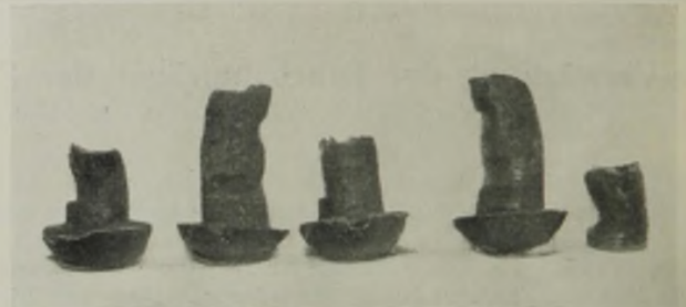
Abb. 5. Beschädigte Niete der Längsträgerverbindungen.
