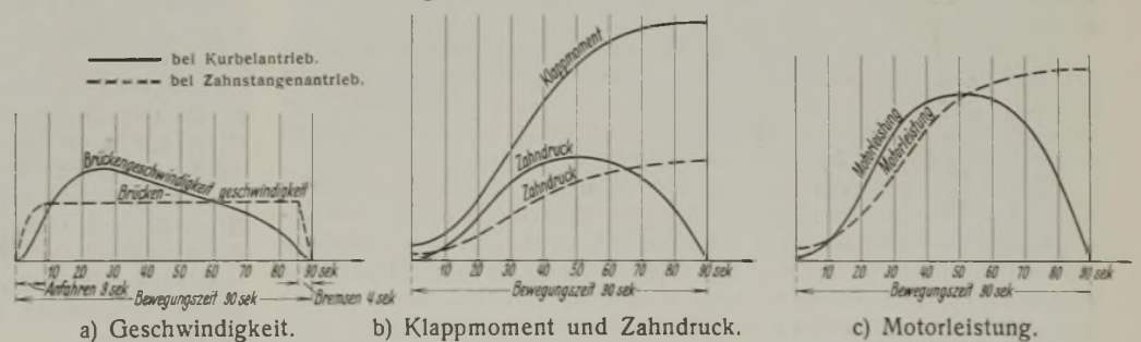
Abb. 14. Vergleichsdiagramme für Kurbel- und Zahnstangenantrieb.
