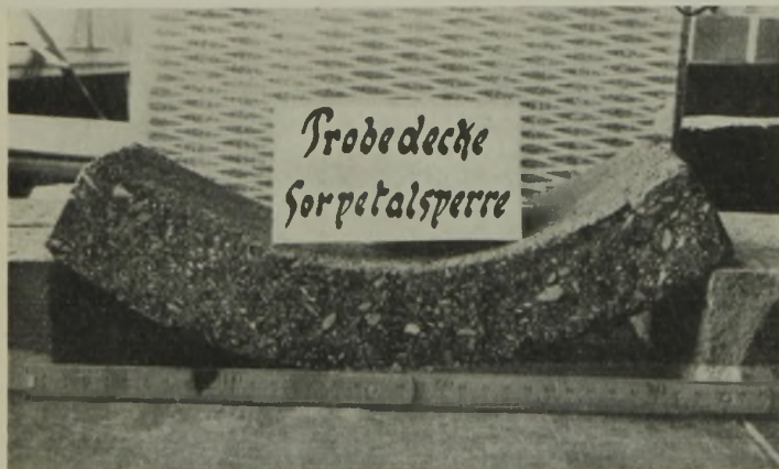
Abb. 17. Biegeprobe. Durchbiegung ohne Rissebildung.
