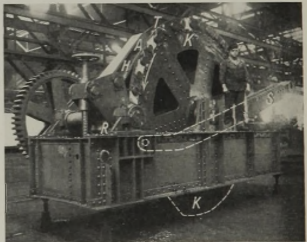
Abb. 12. Kurbelantrieb in der Werkstatt.
