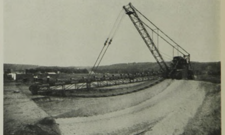
Eimerkettenbagger von 130 m 3 /h Leistung für Baggertiefen bis 17 m.
