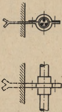
Rys.16. Schemat uchwyty żelaznego do umocowania kabla
