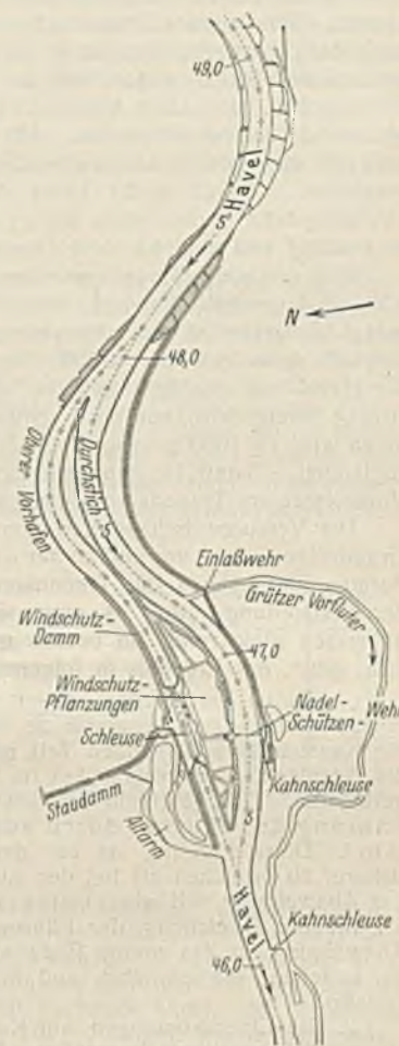
Abb. 15. Staustufe Grütz. Entwurf zur Verlängerung des Oberkanals.
