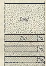
Abb. 5. Mehrere weiche Tonschichten \delta mit Sandzwischenlagen.
