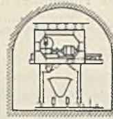
Schematische Darstellung des Förderbetriebes mit „scraper“.
