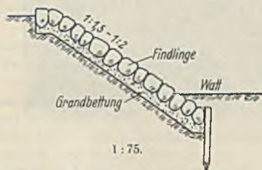
Abb. 20. Querschnitt der ältesten Steindeiche.
