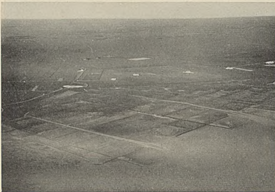
Abb. 41. Flugbild einer Wattfläche mit Lahnungsnetz.
