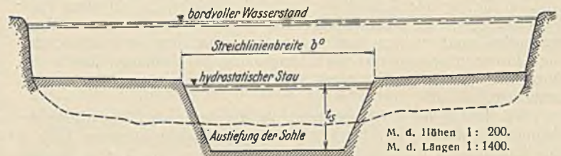
Abb. 3a. Schematischer Querschnitt im oberen Teil einer Haltung.
