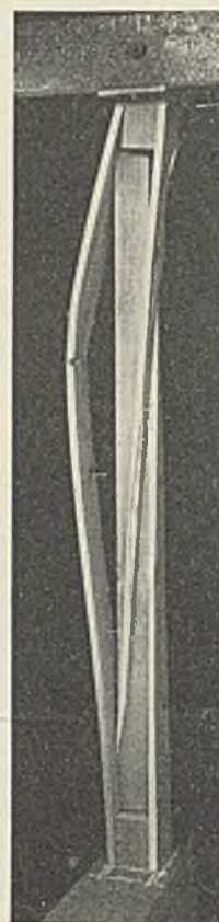
Abb. 5. Gegliedertes Druckstab aus Holz mit durchgehendem Steg und je fünf Nägeln beiderseits unter der Höchstlast.
