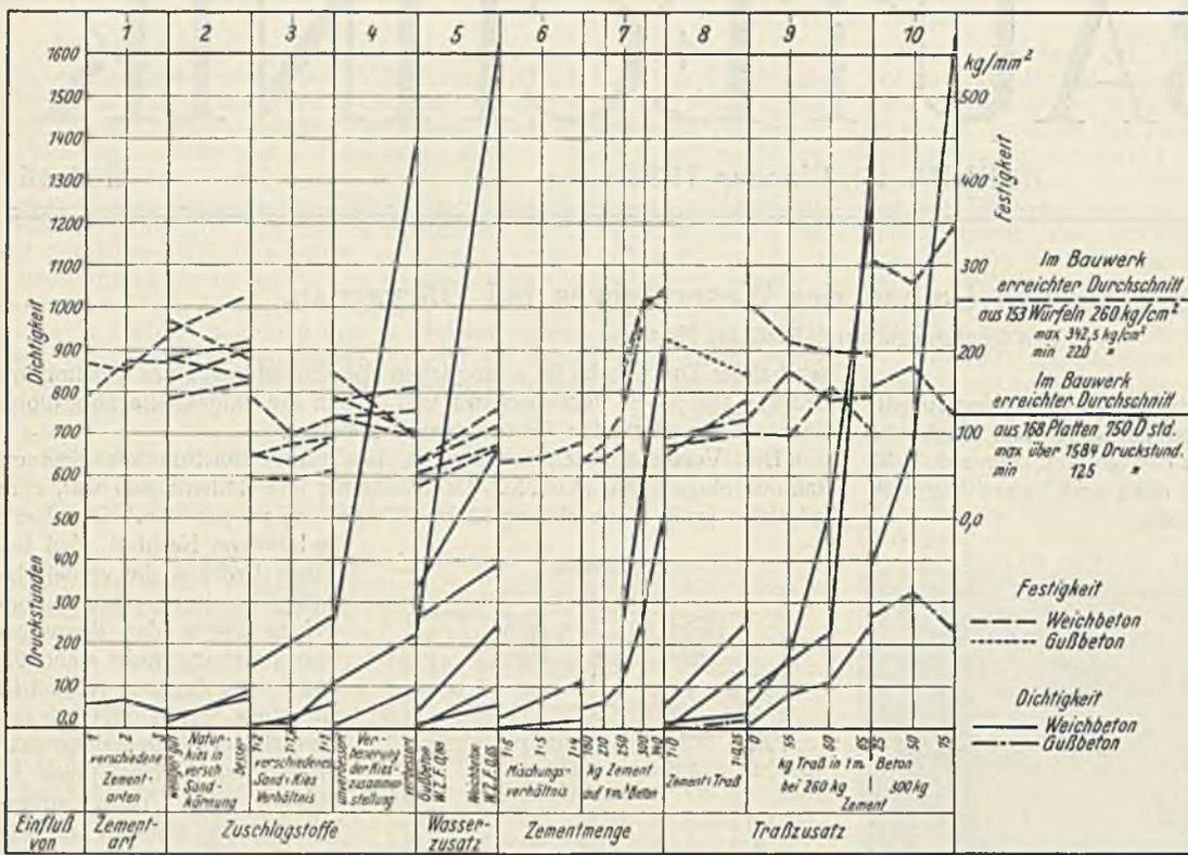
Abb. 3. Versuchsergebnisse über Dichtigkeit und Festigkeit von Beton unter Einfluß verschiedener Faktoren.
