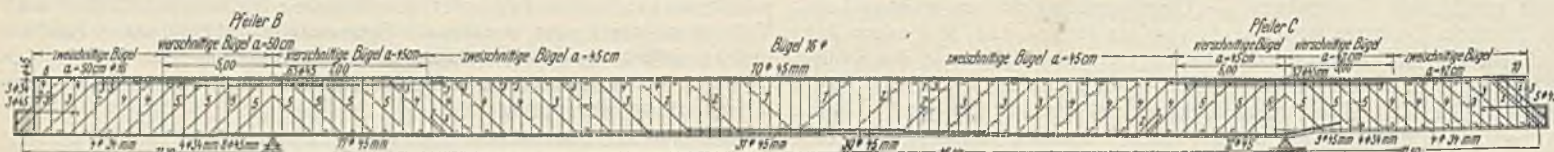
Abb. 10. Bewehrung des äußeren Hauptträgers des mittleren Überbaues.
