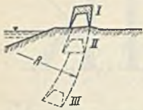
Abb. 4. Absenkzustände der Ufermauer der Abb. 3c.
