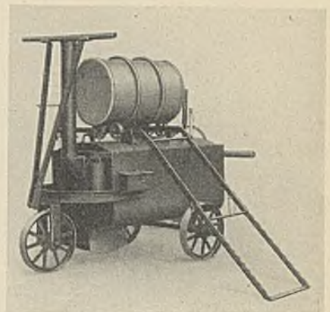
Teer- und Bitumenspritzmaschine, bei der die Handspritzpumpe in den Kessel verlegt ist.
