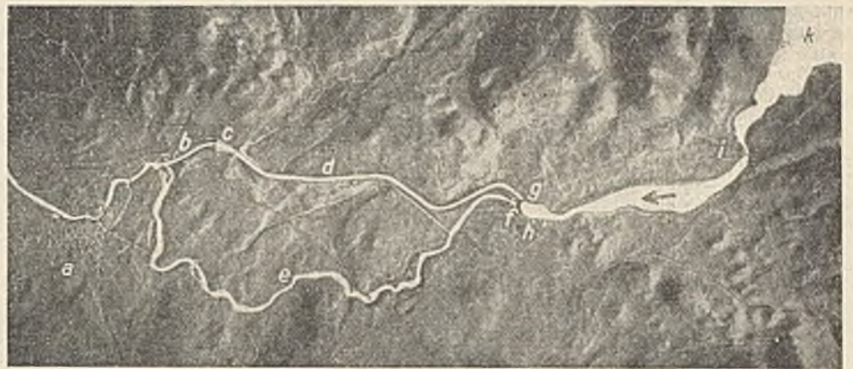
a Limerick. b Unterkanal. c Krafthaus. d Oberkanal. e Shannon-Fluß. f Wehr. g Einlaufbauwerk. h Parteen-Villa. i Killaloe. k Derg-See.
