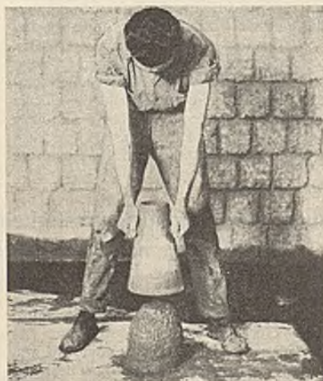
Abb. 2a. Abheben der Setzkegelform.
