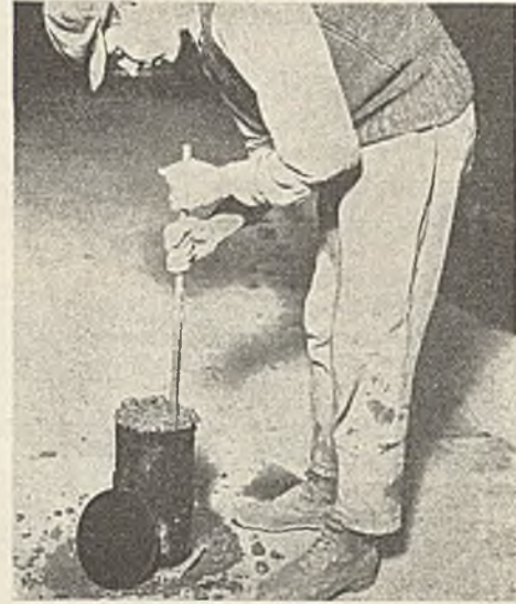
Abb. 10. Genormtes Stampfen der Zuschlagstoffe bzw. des Betondruckzylinders.
