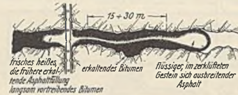
Abb. 3. Schematische Darstellung des Dichtungsvorganges.
