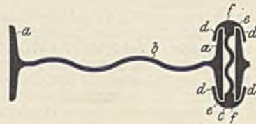
gebogen werden, um die Nuten e zur Aufnahme der Flanschen a zu bilden, der wellenförmige Steg k des Abschlußgliedes besitzt parallele verdickte Schultern f.
