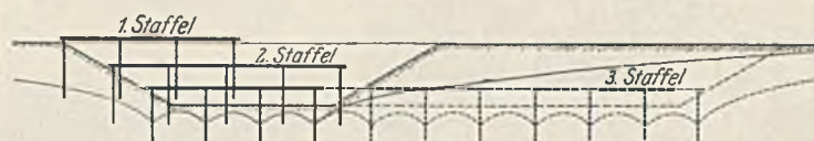
Abb. 2. Trockenlegen einer Baugrube mittels eingeschränkter Staffelsenkung mit unvollkommenem Ausbau der höher gelegenen Staffeln.
