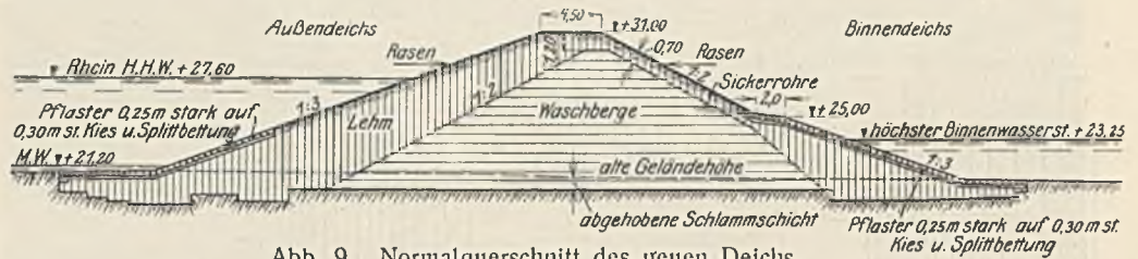
Abb. 9. Normalquerschnitt des neuen Deichs.
