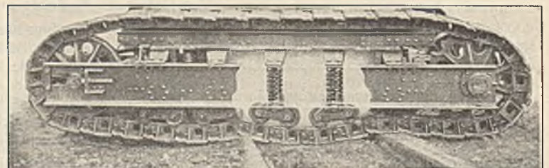
Abb. 4. Raupe mit paarweise federnd ausgeglichenen kleinen Druckrollen (Orton, Chicago).
