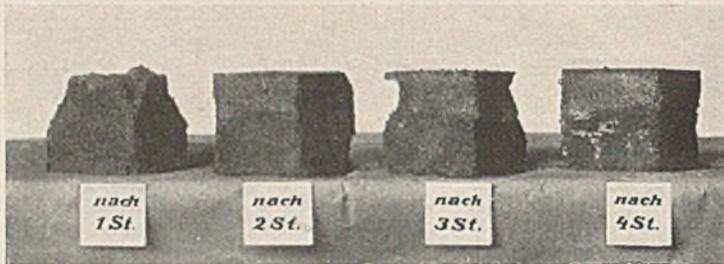
Abb. 3. Mörtelkörper, welche 1, 2, 3 und 4 Stunden nach der Anfertigung in den Formen in das schädliche Grundwasser gebracht wurden, welches die Zerstörungen der Abb. 1 und 2 hervorgerufen hatte.
