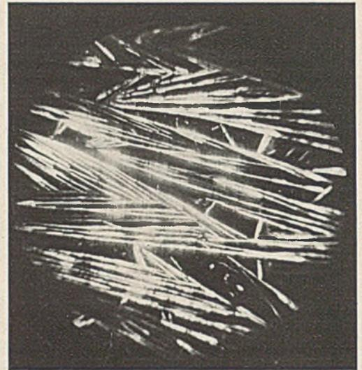
Abb. 4. Kristalle einer schwefelhaltigen organischen Verbindung, durch Benzol aus dem angesäuerten Wasser ausgezogen. (Gekreuzte Nikols.) 80 mal vergr.
