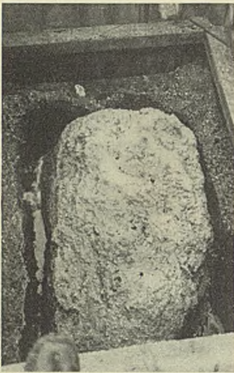
Abb. 7. Chemisch verfestigter Kies, Spritzrohrabstand 1 m.
