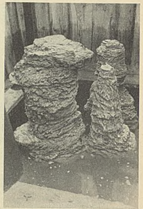
Abb. 8. Chemisch verfestigter Sand, Spritzrohrabstand 1 m.
