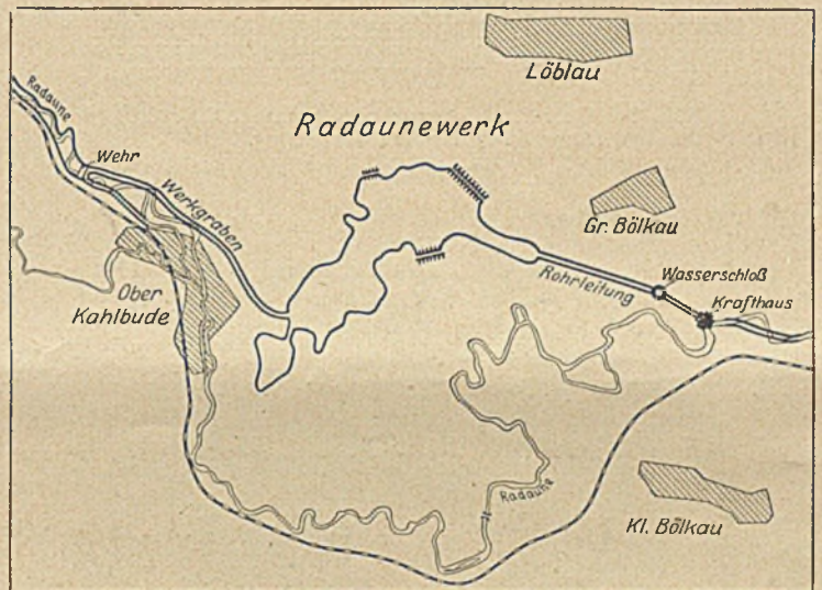
Abb. 1. Lageplan der Wasserkraftanlage Radaunewerk.
