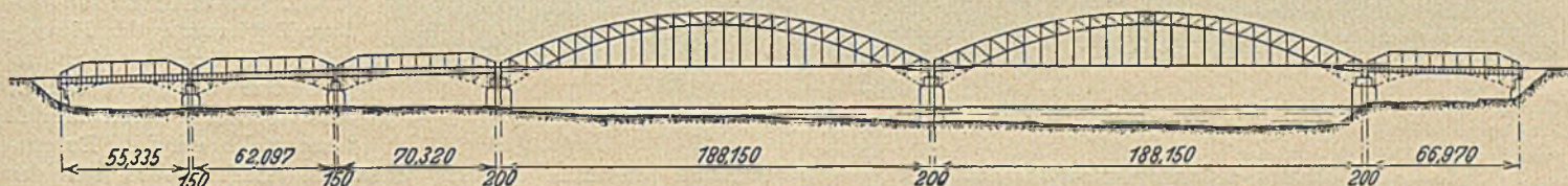
Die sichtbaren Eisenkonstruktionsteile der alten Brücke sind punktiert angegeben
