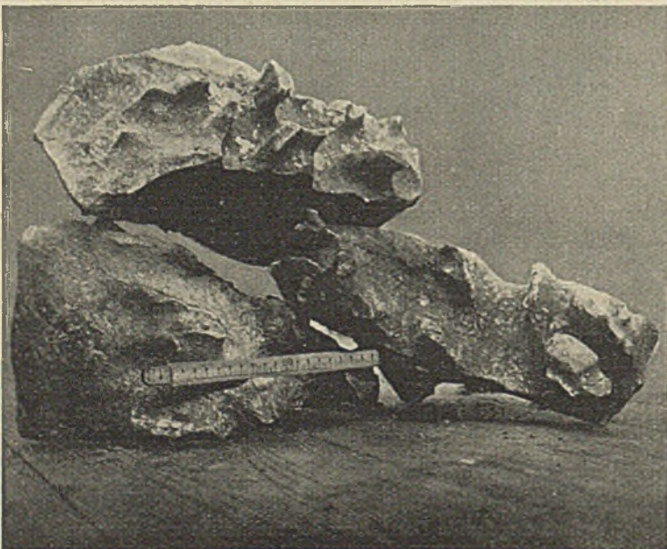
Abb. 5. Ausbruchsteine aus dem Fundament des rechten Ortpfeilers.
