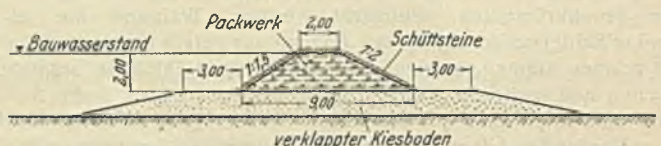
Abb. 5. Querschnitt einer Hilfsbahn.
