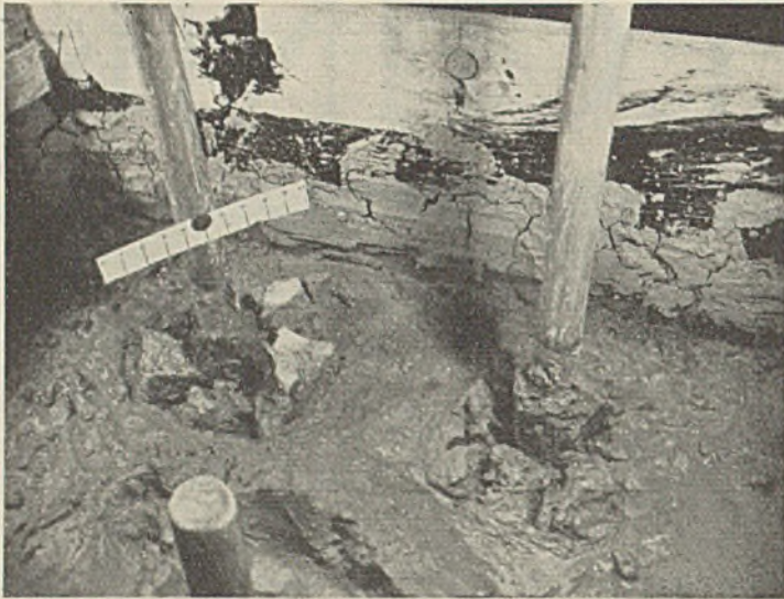
Abb. 7. Pfähle nach dem Zugversuch.
