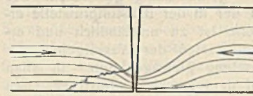
Abb. 13. Absprengen der unteren Kanten bei Druckübertragung in konischen Fugen.
