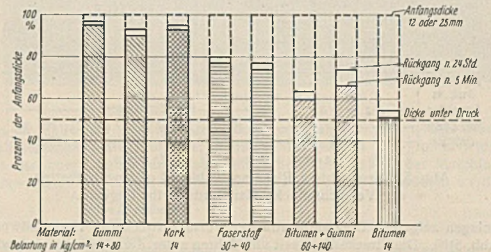
Abb. 4. Elastisches Verhalten von Fugenfüllstoffen.
