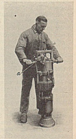
Abb. 4. Explosionsramme mit Magnetzündung.
