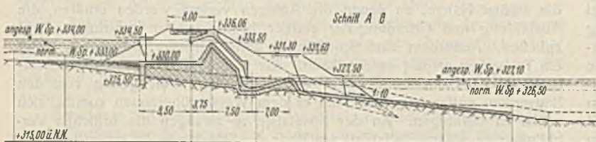
Abb. 103a bis c. Entlastungsanlagen der Vorsperre Sösetalsperre.
