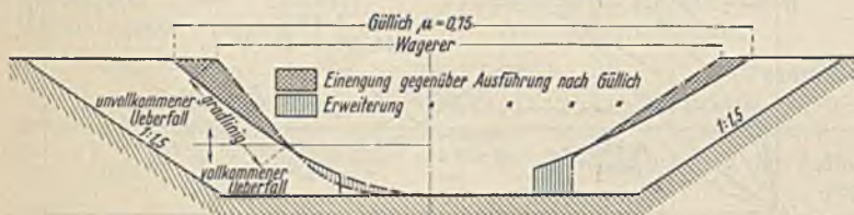
Abb. 37. Absturzquerschnitte in der Weillach mit Verbesserungsvorschlägen nach Wagerer.
