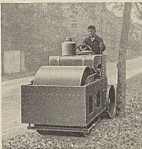
Abb. 3. Leichte Zweiradwalze für schmale bituminöse Straßendecken. Dienstgewicht 2 bis 4 t.
