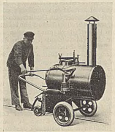
Abb. 5. Fugengießgerät für bituminöse Straßendecken.
