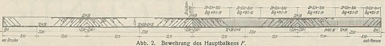
Abb. 2. Bewehrung des Hauptbalkens F.
