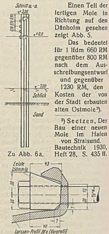
Abb. 6c. Befestigung der Vorprofile an den Leitwerkdalben.
